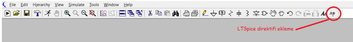
Açılan ekranda “SPICE directive” seçeneği işaretlenerek aşağıdaki kutucuğa “.lib opamp.sub” yazılır “OK” seçeneği seçilir. Üretilen komut devre şematiği üzerinde herhangi bir yere yerleştirilebilir. Bu işlemin ardından ideal davranışlı işlemsel kuvvetlendirici elemanı benzetimde kullanılmaya hazır olacaktır.
